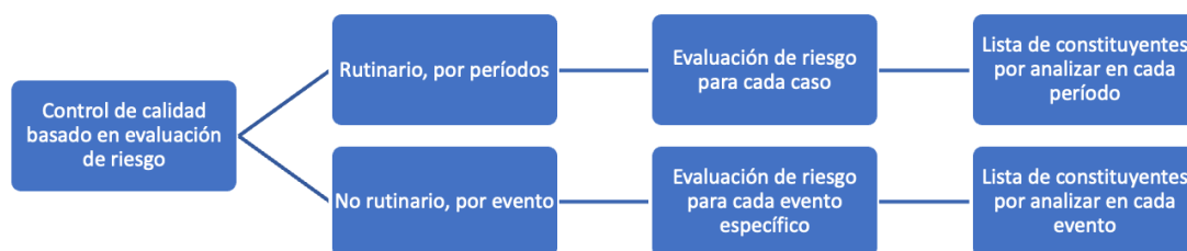
Figura 5-2 Ejemplo de esquema de control basado en evaluación de riesgo (Fuente: elaboración propia)
