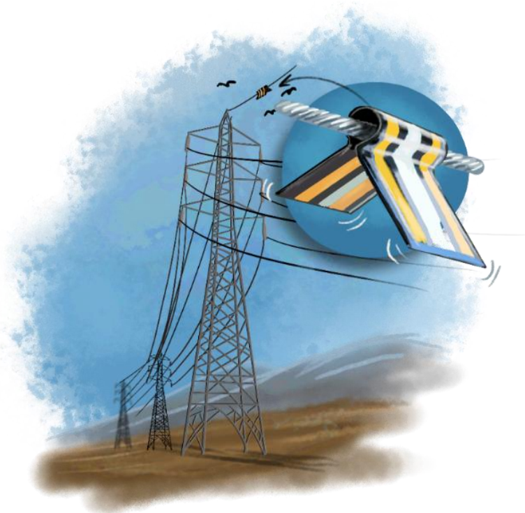
Figura 11. Ubicación de disuasores de colisión en líneas de transmisión eléctrica
