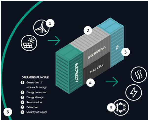
Fig. 2: Esquema conceptual modular e inteligente de la planta industrial H2POWERPLANT de Wilo. Publicado por WIL0 SE.
