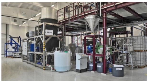
Fig. 1: El centro técnico de K-UTEC cuenta con más de 2.000 m 2 destinados a equipos y sistemas de tecnología de procesos, los cuales pueden combinarse para replicar procesos de producción completos. La planta de demostración a escala industrial permite procesar varias toneladas de materias primas hasta obtener los productos finales deseados.
