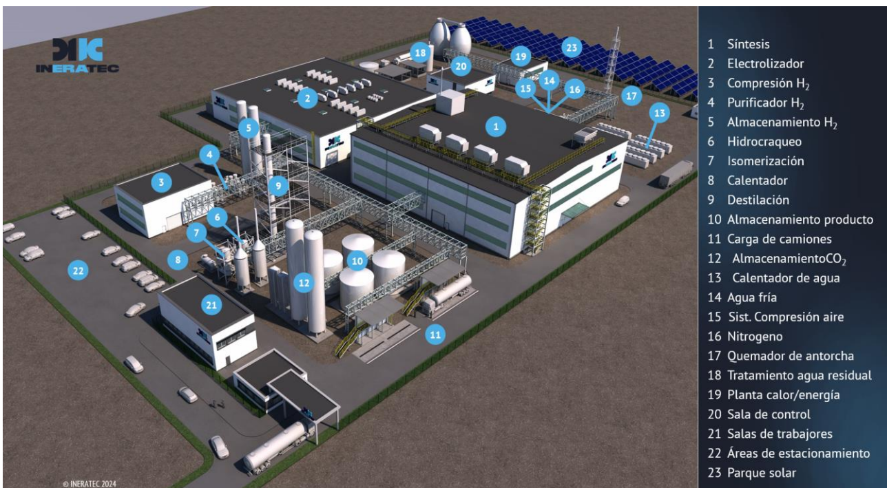
Figura 12. Visualización en 3D de planta de e-Fuels de 50.000 t/a.
