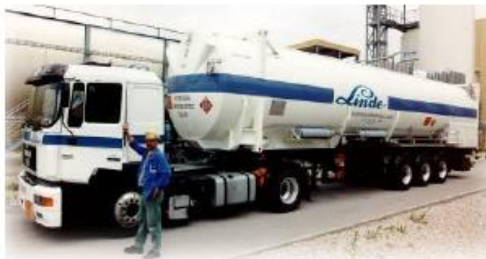
Ilustración 36. Camión cisterna H2 liquido (Fuente: Linde Group)
