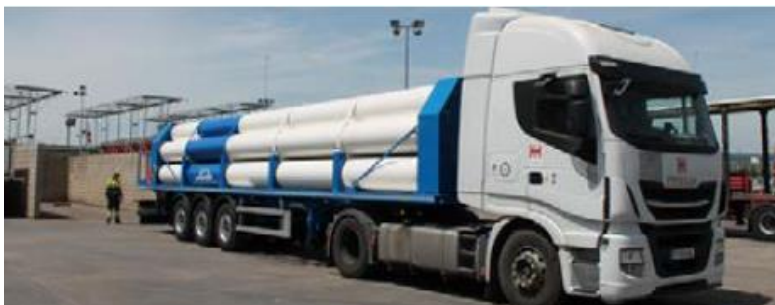
Ilustración 35. Camión de transporte H2 comprimido (fuente: Linde Group, España)
