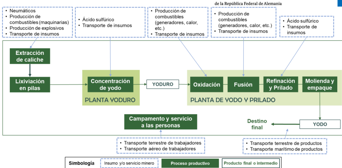
Figura 12. Límite de batería de insumos y servicios del yodo. Fuente: Elaboración propia.
