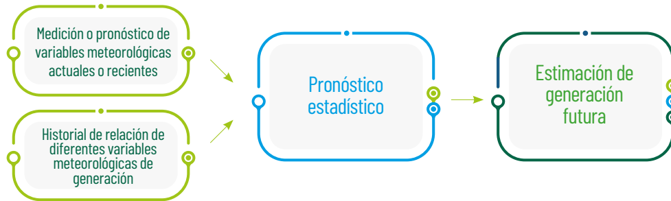
Figura 7. Diagrama de bloques sobre el proceso de pronóstico estadístico
