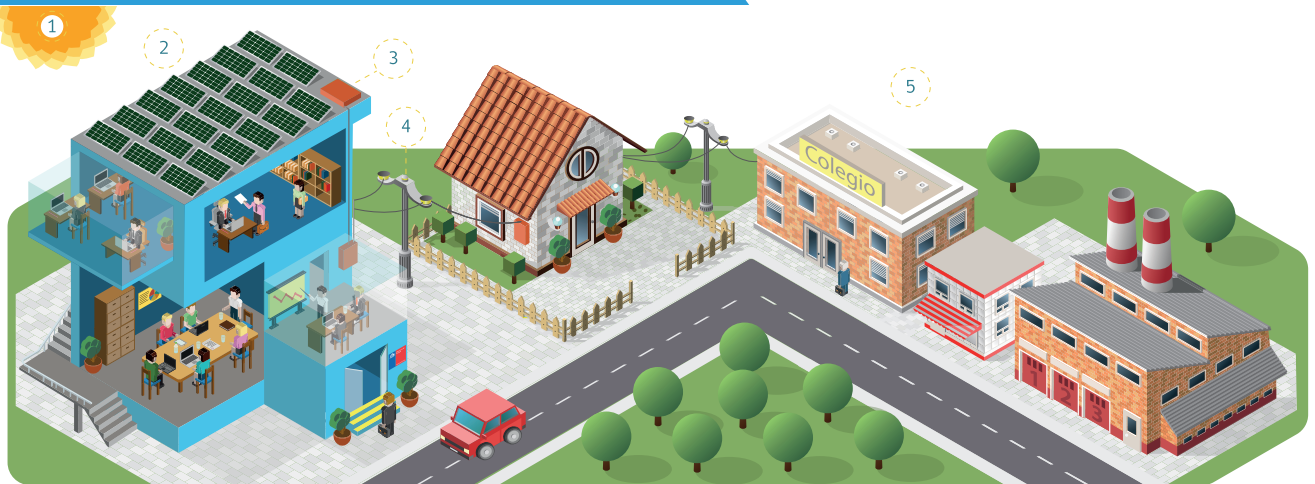
Ilustración 1 Funcionamiento de un sistema FV conectado a red bajo la ley 20.571 (Fuente: Ministerio de Energía)
