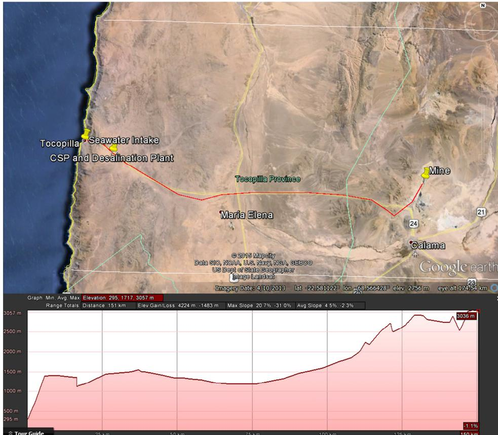
Figura 2-2: Sitio propuesto para la planta de desalinización solar y tubería indicativa desde la captación de agua de mar y hasta el consumidor (mina)<sup>3</sup>
