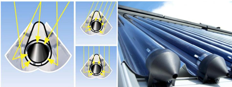
Figura 4-7: Concentrador parabólico compuesto (CPC)<sup>29</sup>
