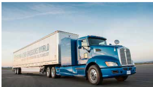
Figura 17: Toyota "Project Portal" – camión transporte pesado con celda de combustible. Fuente: infowars.com.
