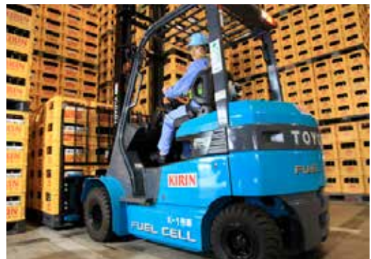
Figura 23: Montacarga en base a celdas de combustible.
