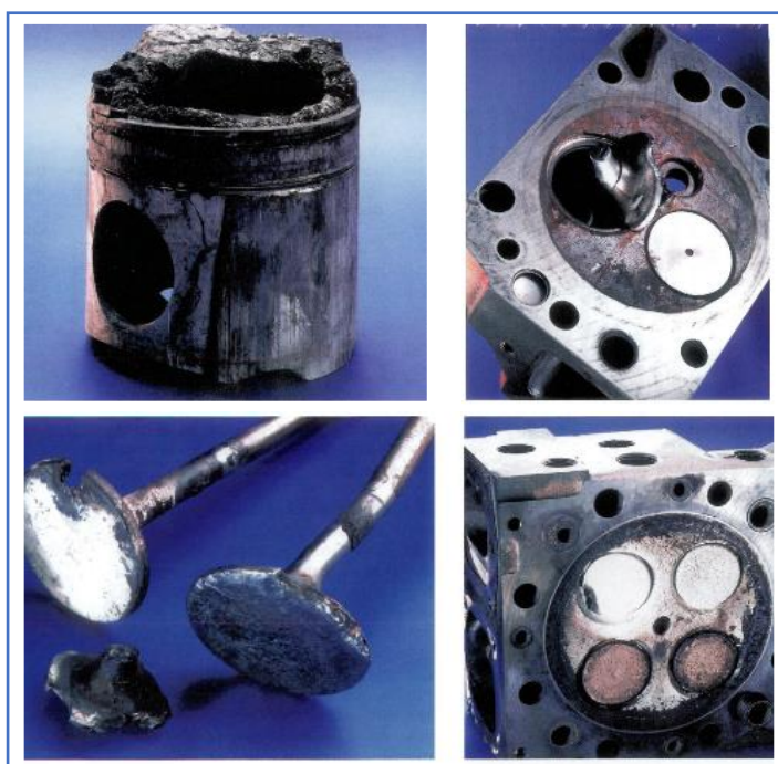
Figura 5-12: Siloxanos Fuente: Infoenviro - Siloxanos
