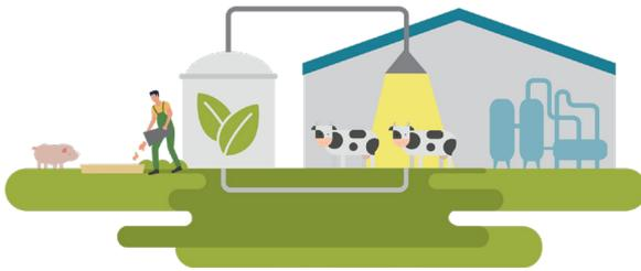
*El biogás es un combustible generado por la descomposición anaeróbica de residuos orgánicos, gracias al trabajo de bacterias. Este biocombustible puede ser utilizado para generar energía eléctrica y/o térmica, así como para la elaboración de biometano. Por otro lado, los efluentes del proceso llamado digestato sirven como fertilizante.*
