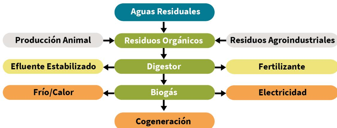
En la producción de biogás la digestión anaeróbica es realizada en reactores herméticos llamados biodigestores o digestores anaeróbicos, los que son alimentados con materia orgánica (residuos como purines, restos vegetales y animales, etc.), y en los que se mantienen condiciones ambientales controladas de temperatura, nivel de acidez y cantidad de materia orgánica dosificada en el tiempo, a fin de favorecer su descomposición y el crecimiento bacteriano.
