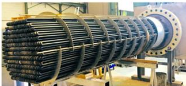
Figura 3: Calentadores de resistencia de sal fundida (Fuente: Vulcanic).
